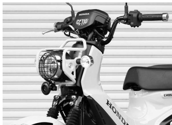
3、ガード①をホーンと純正ボルトで共締め固定します。 (写真 C 参照)
