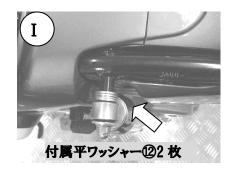
5、付属ロック受けステー⑩を付属 M6 フランジナット⑪で仮固定します。
