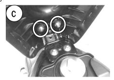
1、ボルト2本とリアショック固定ナットを緩め、純正リアキャリア/リアショックを取外します。
