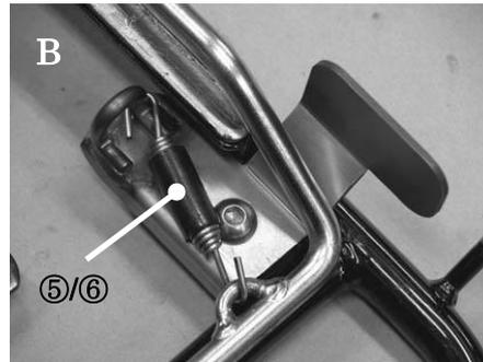
スプリング⑤の引っ掛ける場所及びフック部の向きを確認して、取付けフック先端をベンチ等でつぼめます(動作に支障がない程度につぼめます)
