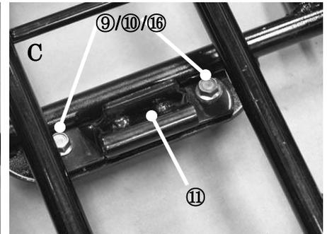
ストッパー①①の向きを確認後ロックバーに差し込んだ状態で組付けます。
