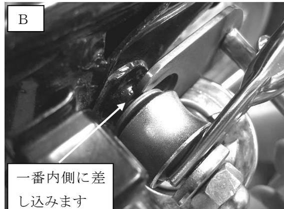
1. 純正のリアサスペンションを固定している純正ナット上下を緩め、サスペンションを手前にならずにフレームとの間に本体を差し込みます。(写真A, B参照)
