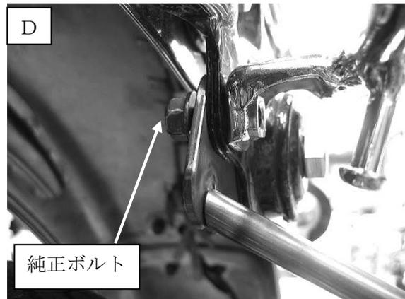
2. 純正グラブレールをとめているボルト外し、フレーム裏側から本体ステーを挟み込みます。(ボルトを取付ける際ネジロック剤の塗布をおすすめします。) (写真C, D参照)
