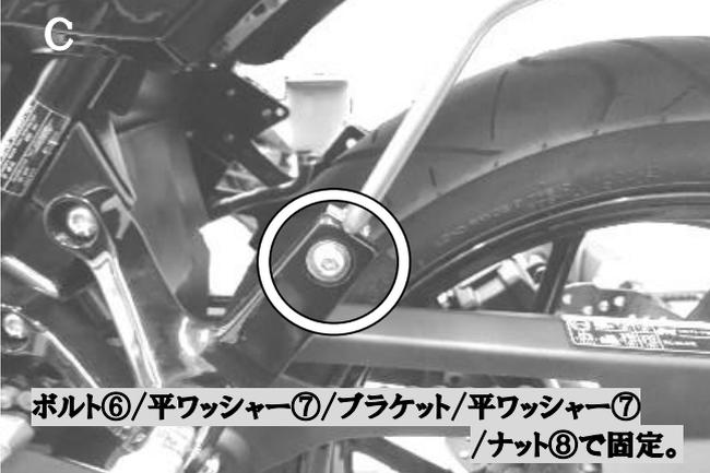
3、タンデムブラケットの後端部の穴にガード①/②とボルト⑥/平ワッシャー⑦/ナット⑧で固定します。
