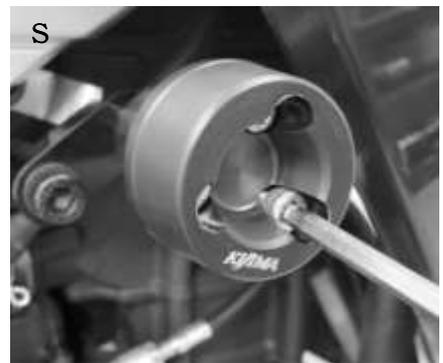
14、マウントボディーをお好みの向きに合わせ、付属ボルト⑥・ロックナット⑦を本締めして下さい。(写真Q・R参照)
