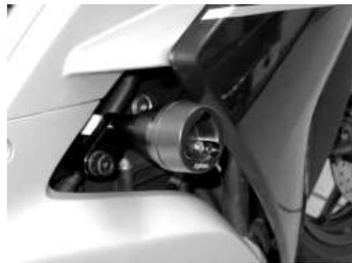
※必ず走行前にボルトの締め付け確認と定期的に増し締めを行って下さい。
