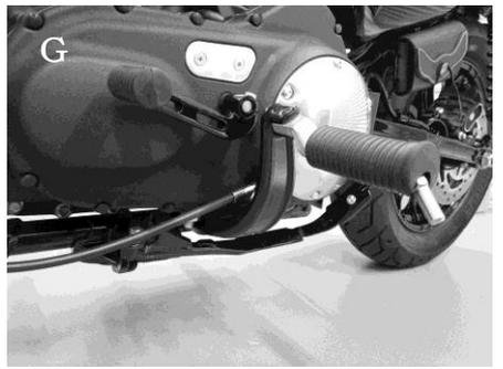
4. ホールプラグを外し、ブラケットL①をフレームに純正ボルトを使用して固定します。(写真EF参照)
