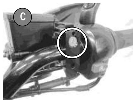
1. 純正マスターシリンダーブラケットを取り外して、付属ブラケット③をセットし付属ボルト④でブラケット上部を固定します。
