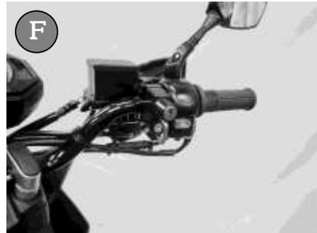
2. 1で固定したブラケット③にヘルメットロック本体①をセットして、付属ボルト⑤を使用してブラケット本体を固定します
