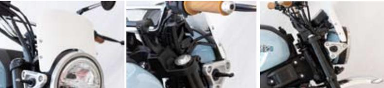
●ネオレトロのイメージを大きく変えるトラッカーイメージのメーターバイザー。ドレスアップ効果はもちろん、小柄ながら防風効果も。ヘッドライトとのクリアランスやフロントフォークに合わせたバイザーの取り付け角度などこだわりが凝縮された一品。●バイザー:FRP製クロゲルコート仕上げ/ステー:スチール製ブラック仕上げ
